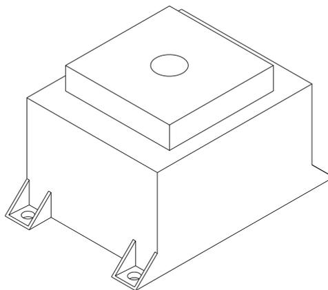
Il *Cicalino Multitensione Intermittente* è un dispositivo realizzato per aumentare la sicurezza degli operatori durante il funzionamento dei veicoli in retromarcia.
